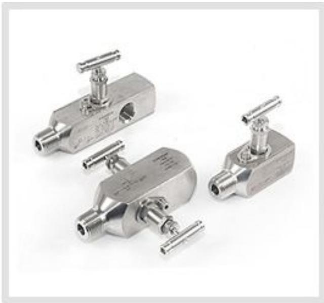
GV манометрический игольчатый вентиль является инструментальным вентилем. Данная регулировочная трубная арматура изготовлена из нержавеющей стали. GV манометрический игольчатый вентиль производится с внутренней и наружной резьбой. Каждый вентиль после изготовления проверяется азотом при 1000 psig (69 бар).
